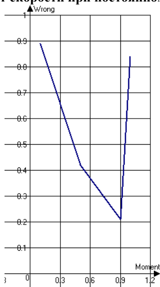
Рис. 6. Зависимость процента распознавания от момента при постоянной скорости
