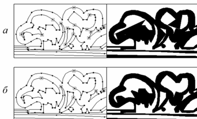
Рис. 13. Наличие незамкнутых контуров: а – неправильно, б – правильно.
